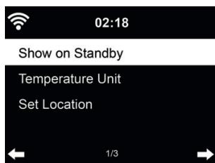
DR 470 è in grado di mostrare le attuali condizioni meteo (fare riferimento a 13.1) in modalità standby. Attivare la schermata di standby e scegliere l'unità di misura della temperatura (°C o °F) da usare per mostrare le condizioni meteo in modalità standby.
