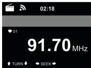
La modalità radio FM riceve le stazioni radio analogiche trasmesse in banda FM.
