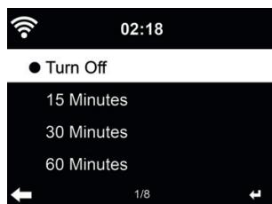
Schalten Sie den Sleeptimer aus oder stellen Sie ihn auf 15/30/60/90/120/150/180 Minuten ein. Ein Bettssymbol mit den verbleibenden Minuten wird oben rechts im Display angezeigt. Nach dem Countdown schaltet sich das DR 470 aus. Drücken Sie **Sleep** auf der Fernbedienung, um diese Funktion direkt aufzurufen.
