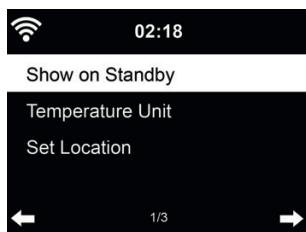
Das DR 470 kann im Stand-by-Modus aktuelle Wetterinformationen anzeigen (siehe Abschnitt 13.1). Schalten Sie das Stand-by-Display ein und stellen Sie die Temperatureinheit ( $^{\circ}\text{C}$  oder  $^{\circ}\text{F}$ ) ein, um im Stand-by-Modus das Wetter angezeigt zu bekommen.
