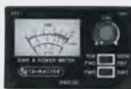
Kombiniertes Stehwellen- u. Leistungsmessgerät, Frequenzbereich: 3,5 - 50 MHz (SWR), 26 - 30 MHz (Power), Leistungsmessbereich: 0 - 10/100 W, Impedanz: 50 Ohm, Genauigkeit: +/- 5%
