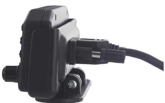
Vista laterale del frontalino montato. Avvitare saldamente le viti del cavo dopo l'assemblaggio!
