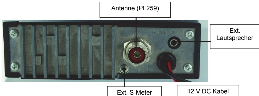
Schließen Sie Ihre CB-Antenne mit einem PL- Stecker an der 50 Ohm Antennenbuchse auf der Rückseite Ihres AE 6891 an. Die Antenne muss auf den CB-Funkbereich abgestimmt sein, damit Sie höchstmögliche Reichweite erzielen können. Benutzen Sie ein
