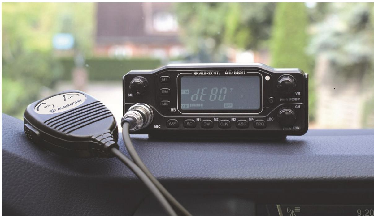
Pour l'installation détachée utilisez le câble à 9 broches Sub-D de 2m inclus.
