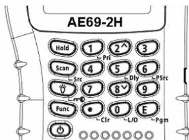
Ihr Scanner hat teilweise Doppelfunktionstasten. Die Erstfunktion ist auf der Taste aufgedruckt, die Zweitfunktion jeweils rechts daneben oder unter den Tasten.
