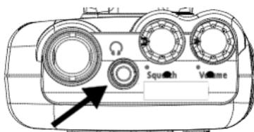
Der eingebaute Lautsprecher schaltet sich automatisch ab, wenn Sie zum ungestörtem Hören einen Kopf- oder Ohrhörer benutzen. Der Hörer kann mit einem 3.5 mm Stereo oder Monostecker versehen sein, beide Systeme sind anschließbar. Beachten Sie die Sicherheitshinweise am Beginn der Anleitung!
