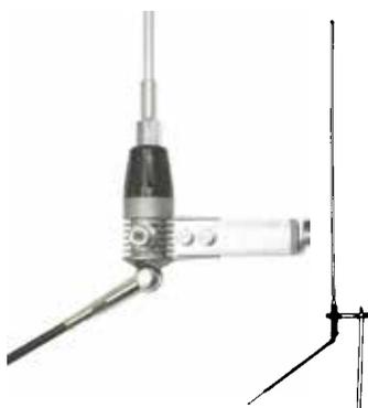
Lambda 1/4 Balkon/ Stationsantenne. Der Aluminiumstrahler hat eine Länge von 275 cm, Radial 173 cm, SWR: <1,2, inkl. Montage-material.
