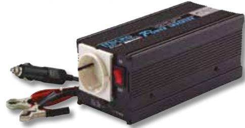
Wechselrichter für max. 300 W Leistung mit Überlastanzeige (LED) und Ventilator zur Kühlung. Für einzelne 230 V Geräte, wie z.B. portable TV Geräte, kleine Stereoanlagen, Videorecorder, Elektronikwerkzeuge und auch größere Lötcolben, Heißklebepistolen, Kühltaschen, Beleuchtung, als 230 V Bordnetz für kleine Wohnwagen, Camper und kleinere Boote. Der INV 300-12/24-USB ist für Eingangsspannungen von 12 oder 24 Volt geeignet.
