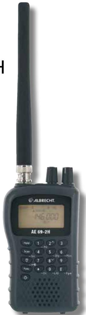
Dieser 80 Kanal Handscanner im kompakten Design ist mit 165 g ein echtes Leichtgewicht. Er verfügt über 3 Bandgruppen mit unterschiedlichen Rastern, einen nicht flüchtigen Speicher für Einstellungen (EEPROM) und die Funktion Hyper Search mit 180 Schritten/Sek. (bei 5 kHz Raster) runden den Komfort ab.
