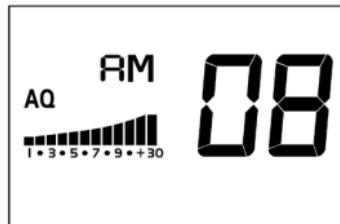
Appuyez à nouveau sur ASQ jusqu'à ce que **ASQ.SET** apparaisse. Vous pouvez maintenant définir l'ASQ en 9 niveaux; le niveau 1 est le plus sensible.
