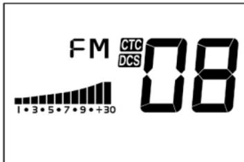
Die aktive CTCSS / DCS Funktion wird im Display mit **CTC oder DCS** angezeigt.
