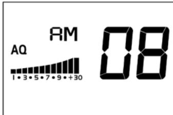
Drücken Sie **ASQ** Taste erneut kurz, bis **ASQ.SET** erscheint. Die ASQ kann nun in 9 Stufen eingestellt werden, Stufe 1 ist die empfindlichste.
