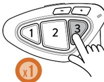
Einmal drücken, um die Konferenz zu dem auf **Taste 3** gekoppelten Gerät zu **öffnen/schliessen**.
