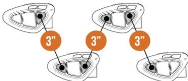
**Hinweis:** der Konferenzmodus erlaubt die gleichzeitige Kommunikation aller Geräte. Die Geräte werden als "Kette" verbunden: die Zurück-Taste des 1.Gerätes muss mit der Vorwärts-Taste des 2.Gerätes usw. gekoppelt sein. Für eine ausführliche Beschreibung schauen Sie in der Gesamtanleitung im Kapitel "Konferenz" oder das Tutorial Video nach.
