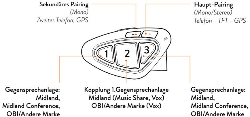
**ACHTUNG:** Um eine Kopplung vorzunehmen, müssen Sie den Setup Modus aufrufen. Wenn Sie die Taste 2 weniger als 7 Sekunden lang drücken, schaltet sich das Gerät ein, anstatt das Setup Modus aufzurufen. Wiederholen Sie in diesem Fall den Vorgang.
