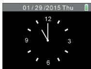
Durante la modalità standby, premere e tenere premuto il pulsante **STANDBY/MODE** per mettere il dispositivo in funzione. Se è la prima volta che si accede alla modalità DAB, il dispositivo effettua automaticamente la scansione delle stazioni DAB/DAB+.
