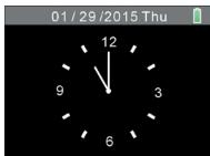
Pour réactiver la radio lorsqu'elle est en veille, appuyez sur la touche **VEILLE/MODE** et maintenez-la enfoncée. Si vous activez le mode radio numérique pour la première fois, la radio démarre automatiquement une recherche de stations DAB/DAB+.
