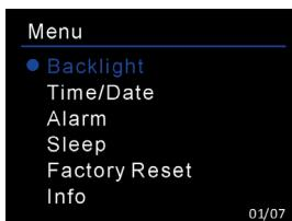
Wählen Sie die Stärke der Hintergrundbeleuchtung (hoch/mittel/niedrig) und die Leuchtdauer (On/10/20/30/45/60/90/120/180 Sek.). Durch Einstellung der Leuchtdauer wird die Hintergrundbeleuchtung automatisch gedimmt, wenn in der eingestellten Zeit auf keine Funktionen des Geräts zugegriffen wird.
