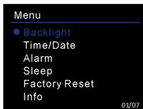
Selezionare il **Livello** della retroilluminazione (High/Medium/Low) e la durata del **Timeout** (On/10/20/30/45/60/90/120/180 sec). Selezionando una durata di timeout, il display si spegnerà automaticamente in caso di assenza di operazioni per il tempo indicato.
