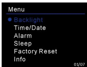
Sélectionnez le niveau du rétroéclairage (High/Medium/Low) et sa durée **Timeout** (On/10/20/30/45/60/90/120/180 sec). En définissant une durée pour le rétroéclairage, l'écran s'éteint automatiquement si aucune opération n'est effectuée pendant la période sélectionnée.
