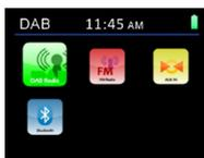
Drücken Sie kurz die Taste **STANDBY/MODE**, um zum Hauptmenü zu gelangen. Indem Sie den Drehknopf drehen, können Sie verschiedene Betriebsmodi auswählen (**DAB**, **FM (UKW)**, **AUX IN** oder **Bluetooth**) und drücken Sie danach den Drehknopf (**OK**) zur Bestätigung.
