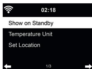
DR 883 è in grado di mostrare le attuali condizioni meteo (fare riferimento a 16.1) in modalità standby. Attivare la schermata di standby e scegliere l'unità di misura della temperatura (°C o °F) da usare per mostrare le condizioni meteo in modalità standby.
