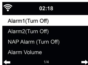
Il y a trois alarmes indépendantes : 2 alarmes d'heure absolue (**Alarm 1 et Alarm 2**) et une alarme pour l'heure relative (**NAP Alarm**). Appuyez sur **Alarm** de la télécommande pour accéder directement à ce menu.
