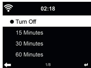
Disattivare o impostare a 15/30/60/90/120/150/180 minuti il timer di auto-spegnimento. Dopo l'impostazione di tale tempo, apparirà nell'angolo in alto a destra un'icona a forma di letto con l'indicazione dei minuti che restano. Il DR 883 si spegne alla scadenza del tempo impostato. Premere il pulsante **Sleep** sul telecomando per l'accesso rapido a questa funzione.
