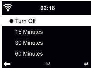
Schalten Sie den Sleeptimer aus oder stellen Sie ihn auf 15/30/60/90/120/150/180 Minuten ein. Ein Bettsymbol mit den verbleibenden Minuten wird oben rechts im Display angezeigt. Nach dem Countdown schaltet sich das DR 883 automatisch aus. Drücken Sie **Sleep** auf der Fernbedienung, um diese Funktion direkt aufzurufen.
