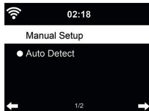
C'è un'opzione di scelta rapida **Local Radio** nel menù Internet Radio (vedi sezione 8.2), che consente di raggiungere facilmente le stazioni radio della propria località. La propria località può essere impostata manualmente (opzione **Manual Setup**), oppure far sì che il sistema individui automaticamente (opzione **Auto Detect**) la propria posizione attuale. Il sistema individua la posizione in base all'indirizzo IP della propria connessione di rete.
