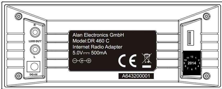
Pour le modèle illustré, vous avez accès aux connecteurs suivants : 2 x connecteurs RCA stéréo et 1 x connecteur d'alimentation électrique
