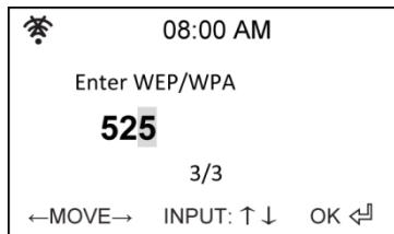
4. Inserire la frase di accesso corretta e premere Invio per stabilire una connessione. Per i dettagli sull'inserimento del testo, fare riferimento alla sezione "9.3 Inserimento testo".
