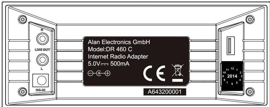
Die Anschlüsse dieses Modells sind: 2 x Stereo Cinch und Netzteileingang
