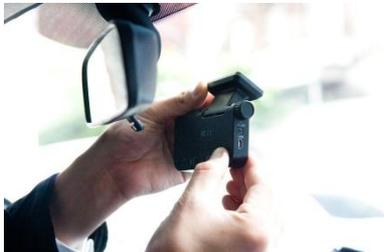
**4.** Befestigen Sie das K11 mit der Winkel-Einstellschraube vorübergehend locker, senkrecht von der Seitenansicht.
