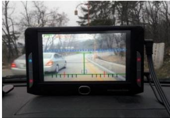
**10.** Wenn die „rote“ und „blaue“ LED aufleuchten und das Bild des Bereichs vor dem Fahrzeug auf dem Monitor angezeigt wird, ist die grundlegende Installation des K11 abgeschlossen.
