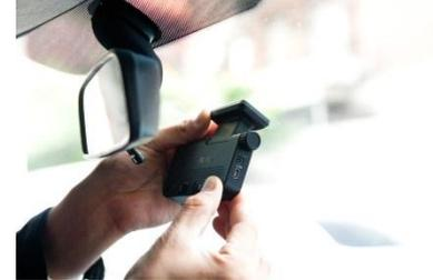
**3.** Setzen Sie das K11 in die Halterung ein und achten Sie darauf, dass es mit der Winkel-Einstellschraube senkrecht (von der Seite aus gesehen) befestigt ist.
