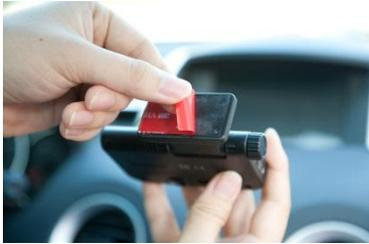
**2.** Installieren Sie die Halterung gut und waagrecht an der Windschutzscheibe hinter dem Rückspiegel.
