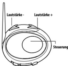
Das BT City hat 3 Multifunktions Tasten und 3 Kabelanschlüsse auf der Unterseite.
