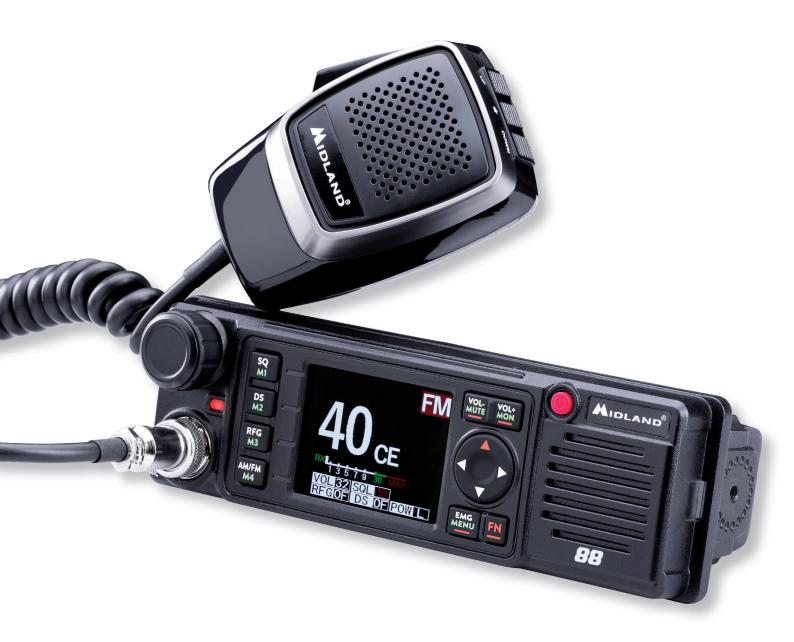
Das Midland M-88 CB-Funkgerät kommt als viertes Modell der neuen Midland M-Serie im frischen High-Tech-Design in kompakter Form daher. Es besitzt ein großes Farbdisplay auf der Vorderseite. Das M-88 deckt selbstverständlich alle europäischen Ländernormen ab und kann sowohl mit 12V als auch 24V betrieben werden. Das Feature DS (Digital Squelch) gewährleistet stets einen sauberen Empfang, ohne störende Nebengeräusche.
