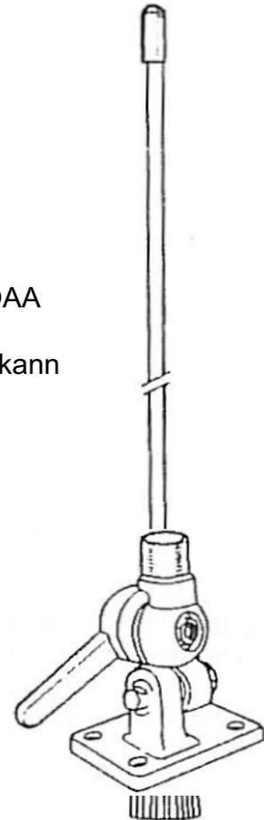
Der Klappfuß erlaubt das Verstellen in zwei Ebenen. Bei evtl. Demontage beachten Sie die Einzelteile entsprechend der beigelegten Zeichnung.
