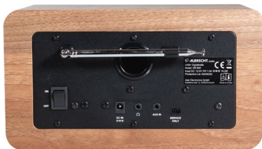
Alle Anschlüsse des Gerätes befinden sich auf der Rückseite. Positiv fällt auch der links sichtbare Netzschalter auf, der es erlaubt, das Netzteil zu ziehen das Radio stromlos zu setzen
