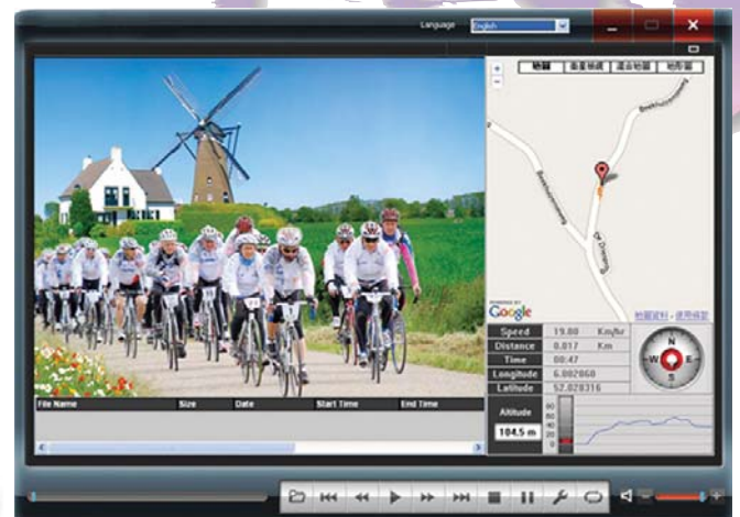
Anzeige von Wegstrecke, Geschwindigkeit, Kompass, Entfernung, Zeit, Höhe
