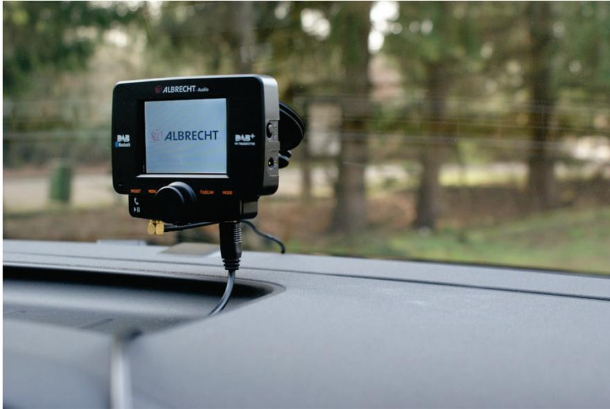
6. Stellen Sie nun die Frequenz des FM Transmitters auf eine freie Frequenz ein. Dazu drücken Sie TX/Scan und drehen den Kontrollknopf.
