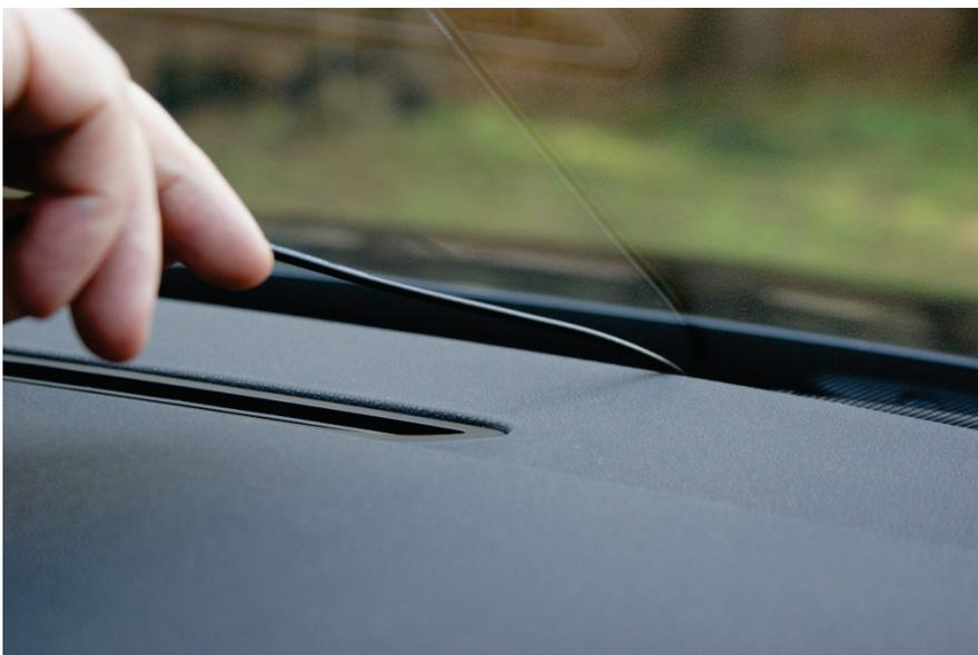
3. Die Antenne wird im unteren rechten Bereich der Windschutzscheibe aufgeklebt. Für beste Empfangseigenschaften sollte die Kupferfolie direkt auf die Metallkarosserie des Autos geklebt werden. Dazu müssen Sie die Verkleidung entfernen. Die Vorgehensweise dazu variiert mit dem Fahrzeugtyp. Aber auch ohne direkten Kontakt bietet die Antenne sehr gute Empfangseigenschaften.
